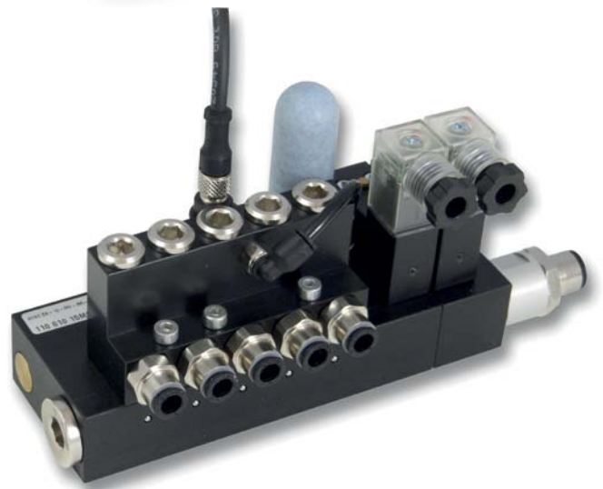
Bild eines MULTIKREIS-Ejektors mit Magnetventil gesteuertem Abblasen und AVAC Monitoring System (AMS) und sowie mit MULTI Druckluftversorgungsventil und Vakuum Halteventilen.
